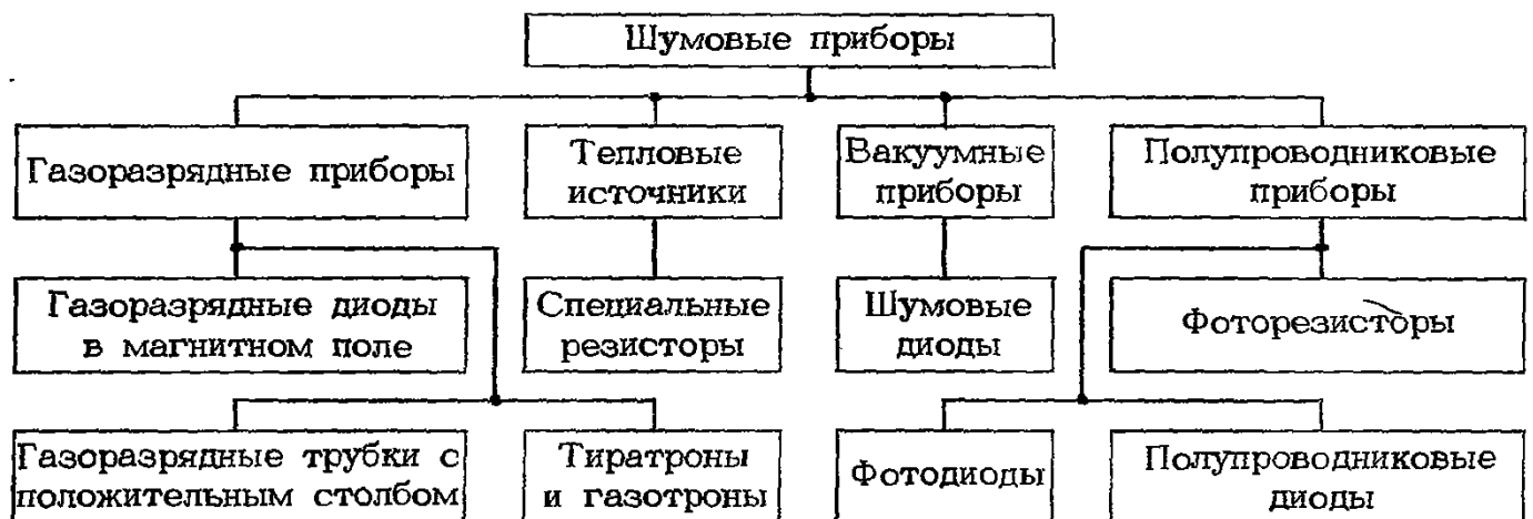
Рис. 13.19. Классификационная схема основных приборов, используемых в качестве первичных источников шума
