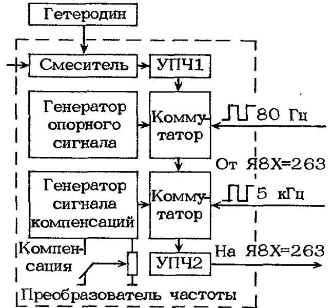
Рис. 13.13. Структурная схема преобразователя частоты измерителя коэффициента шума Х5-16
