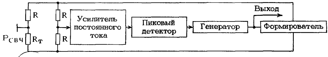
Рис. 3.65. Схема частотно-импульсного самобалансирующегося моста
