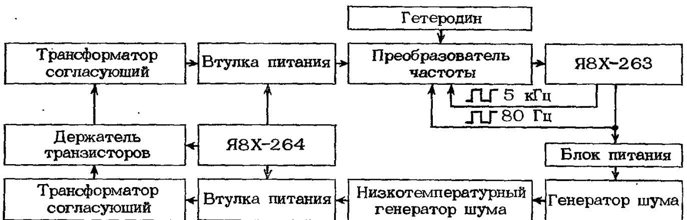
Рис. 13.12. Структурная схема измерения температуры шума транзисторов
