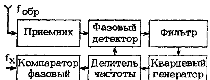
Рис. 7.20. Структурная схема измерения частоты приемником-компаратором с синхронизируемым кварцевым генератором
