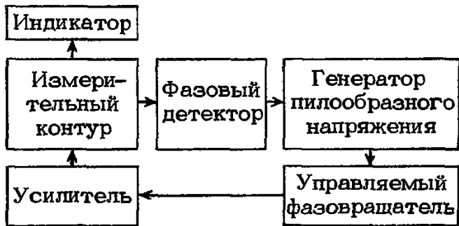
Рис. 6.6. Структурная схема широкодиапазонного измерителя добротности
