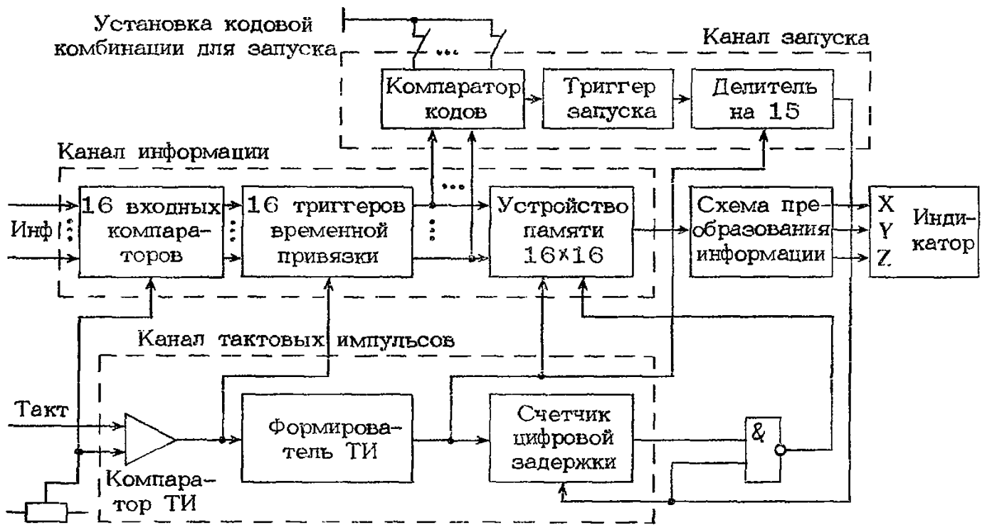
Рис. 16.28. Структурная схема анализатора 806
