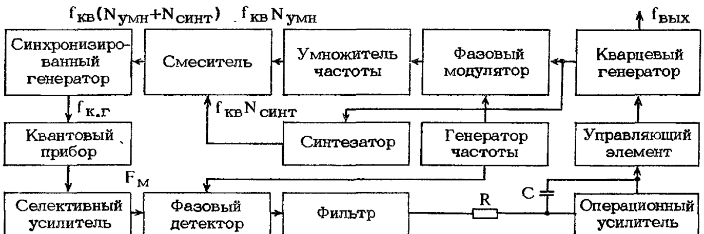
Рис. 7.59. Структурная схема пассивного квантового стандарта частоты с синтезатором, включенным вне линейки умножения частоты
