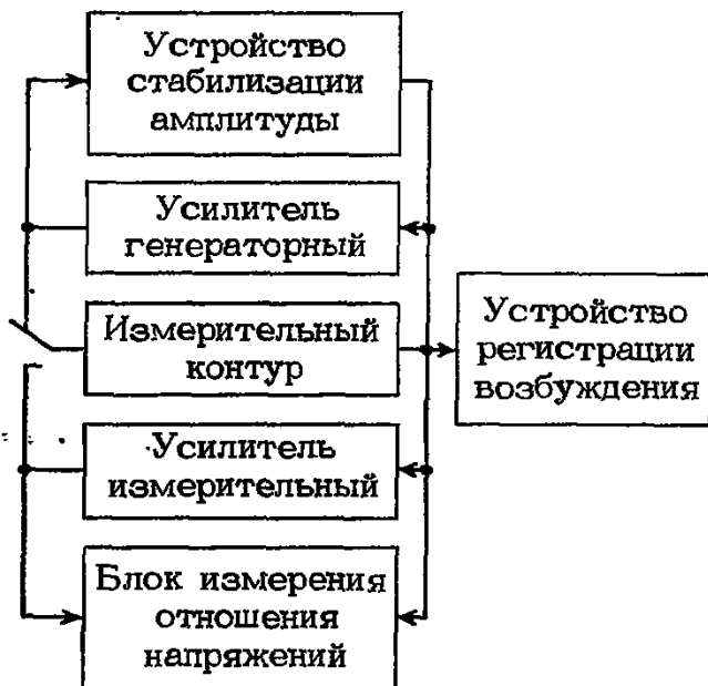
Рис. 6.5. Структурная схема измерителя добротности с положительной обратной связью
