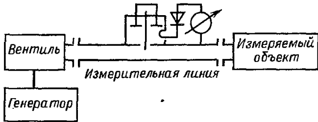
Рис. 5.5. Функциональная схема измерительной линии
