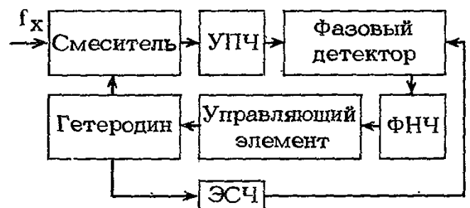
Рис. 7.8. Структурная схема измерения частоты при помощи ЭСЧ и переносчика с ФАПЧ гетеродина по частоте измеряемого сигнала
