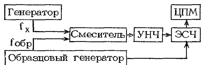
Рис. 7.36. Способ измерения кратковременной нестабильности частоты при помощи гетеродина и ЭСЧ, работающего в режиме измерения периода
