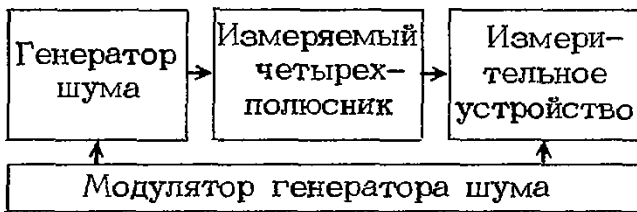
Рис. 13.4. Упрощенная структурная схема модуляционного метода измерения коэффициента шума четырехполосника
