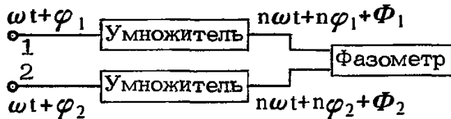
Рис. 8.1. Структурная схема преобразования фазы методом умножения частоты
