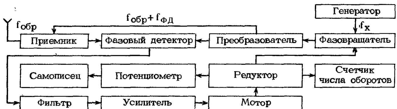
Рис. 7.21. Структурная схема измерения частоты приемником-компаратором со следящей системой
