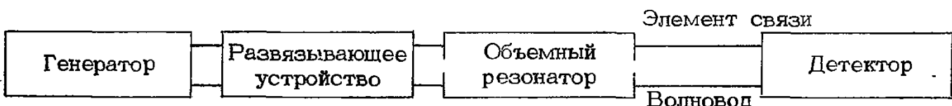
Рис. 6.12. Эквивалентная схема контура СВЧ с двумя входами
