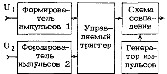
Рис. 8.39. Структурная схема фазометра с усреднением
