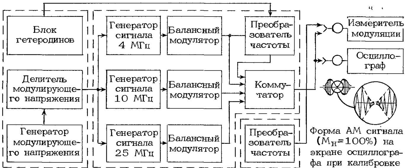
Рис. 15.9. Структурная схема установки К2-34
