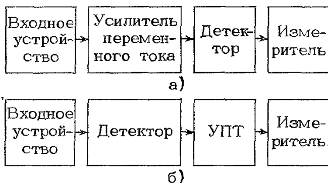
Рис. 2.53. Структурные схемы электронных аналоговых вольтметров
