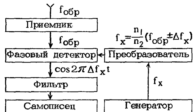
Рис. 7.18. Структурная схема измерения частоты приемником-компаратором с фазовым детектором
