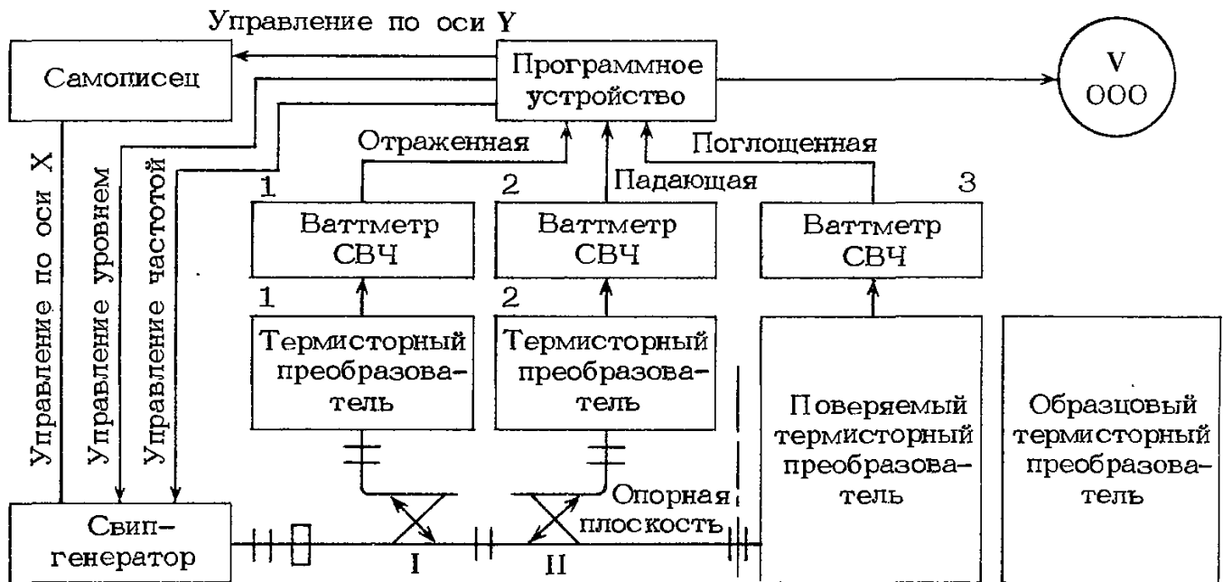
Рис. 3.71. Структурная схема автоматизированной установки для измерения K_3
