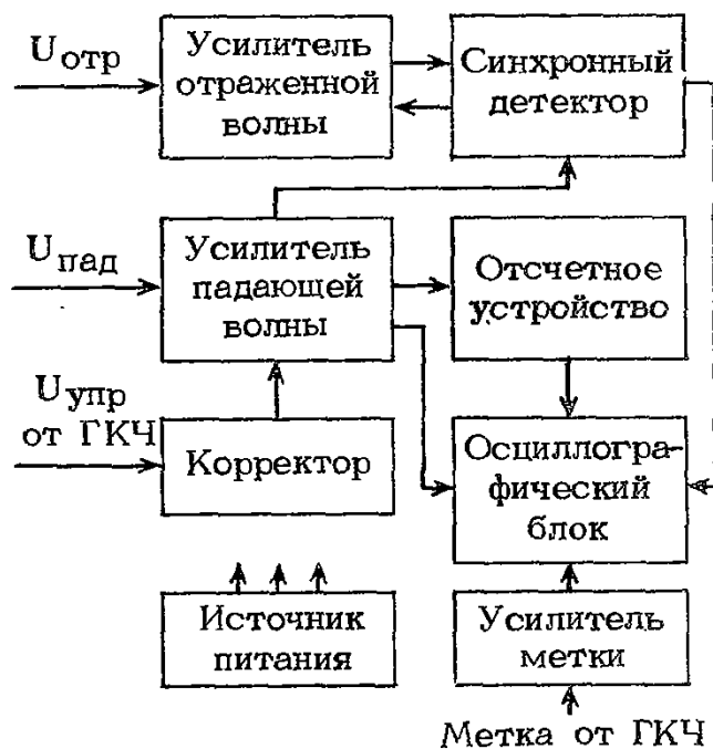
Рис. 5.10. Структурная схема индикатора КСВ и ослабления
