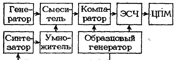
Рис. 7.40. Структурная схема измерения кратковременной нестабильности частоты при помощи компаратора
