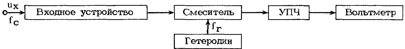
Рис. 2.76. Структурная схема селективного вольтметра
