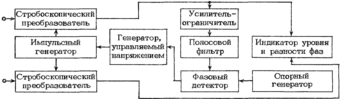
Рис. 8.31. Измеритель фазы со стробоскопическим преобразователем частоты
