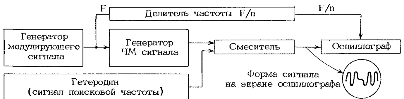
Рис. 15.8. Структурная схема измерения девиации частоты осциллографическим методом
