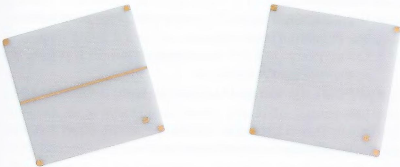
Рис. 4.2.1 Микрополосковая линия как проходной стандарт (слева) и подложка без линии передачи как стандарт симметричной цепи (справа).
