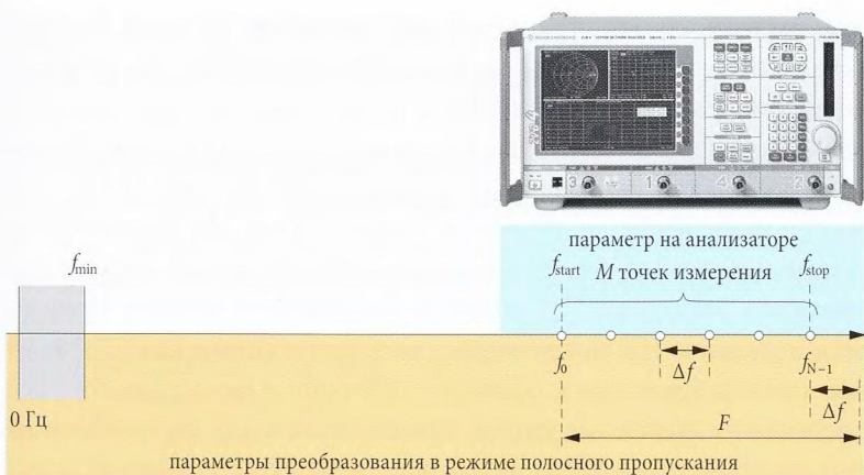
Рис. 5.3.4 Сравнение параметров анализатора и характеристик преобразования в полосно-пропускающем режиме.
