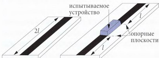
Рис. 3.3.14 Проходной переход и подложка для измерений.
