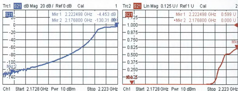
Рис. 4.4.1 Измерение передачи фильтра с большой полосой пропускания.
