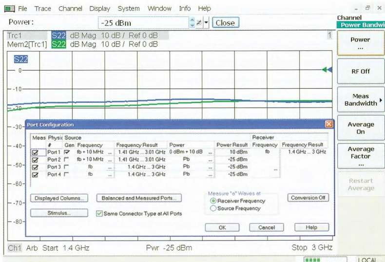
Рис. 7.7.2 Установки примера для произвольного режима для измерения горячего параметра s_{22} с помощью R&S® ZVA 24.
