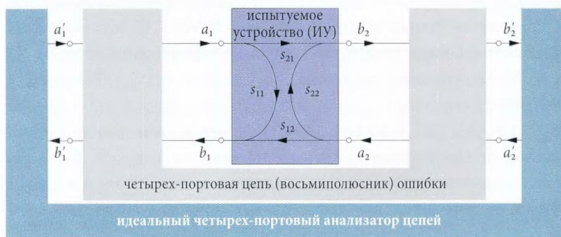
Рис. 3.4.7 15-компонентная модель ошибки.
