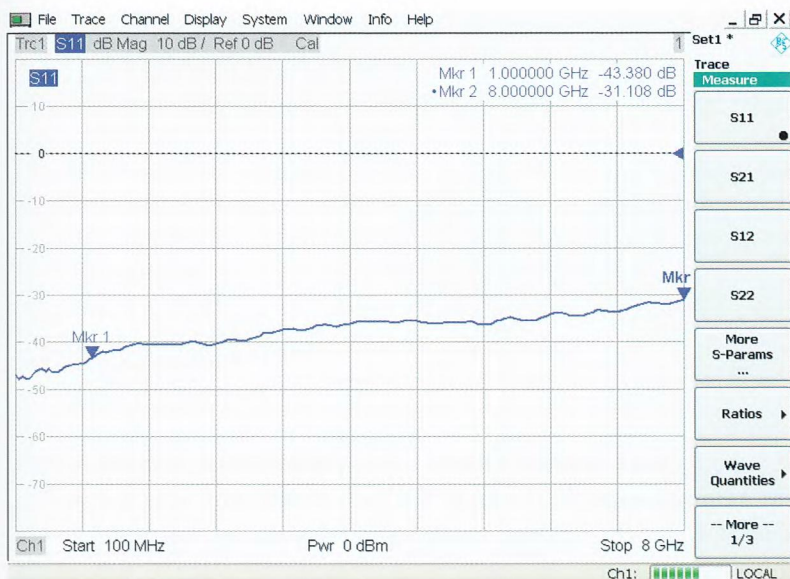
Рис. 4.3.3 Контроль согласования высококачественного фиксированного аттенуатора.
