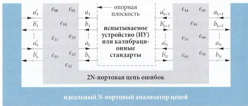
Рис. 3.2.2 Виртуальное разделение реального N-портового анализатора цепей на выделенную 2N-портовую цепь искажающей и идеальный N-портовый анализатор цепей.
