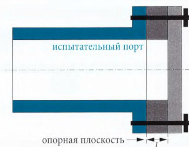
Рис. 3.3.11 Смещенная нагрузка КЗ.
