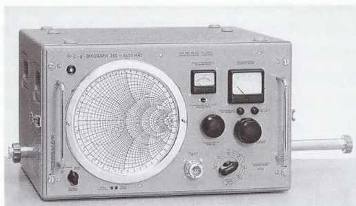
Рис. 10.1.1 Знаменитый двумерный Диаграф – векторный анализатор цепей из семейства Rohde&Schwarz, который изготавливался с 1950 по 1977 годы.
