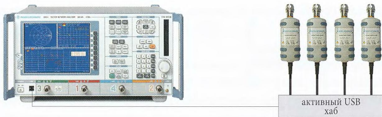
Рис. 7.1.10 Анализатор цепей R&S®ZVB4 с четырьмя датчиками мощности R&S®NRP-Z51.
