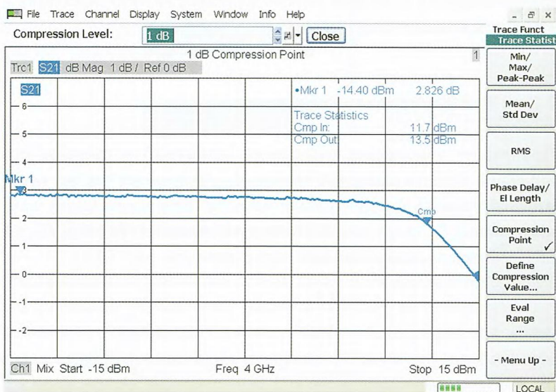
Рис. 7.2.2 Измерение точки компрессии усилителя.
