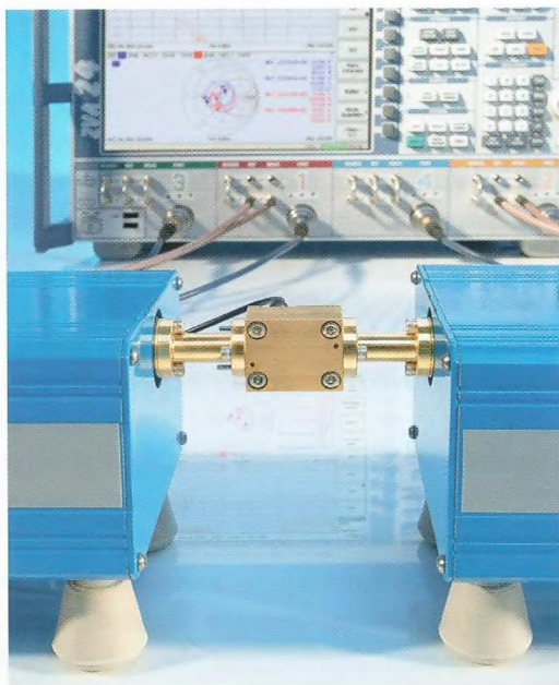
Рис. 8.5.7 Усилитель миллиметро- вого диапазона (Фраун- гоферовский институт) как ИУ на модулях частотного расширения Oleson V03VNA2-T/R.
