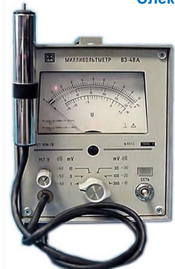
Вольтметр среднеквадратического значения 0,3мВ - 300В, 50 МГц.
