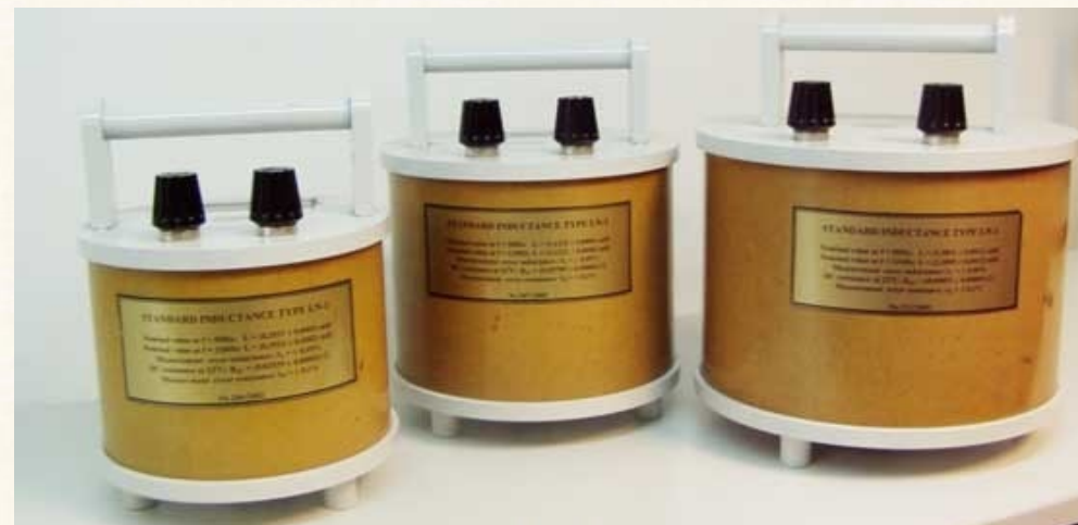
Рис. 5.6. Образцовые катушки: а) индуктивности, б) взаимной индуктивности
