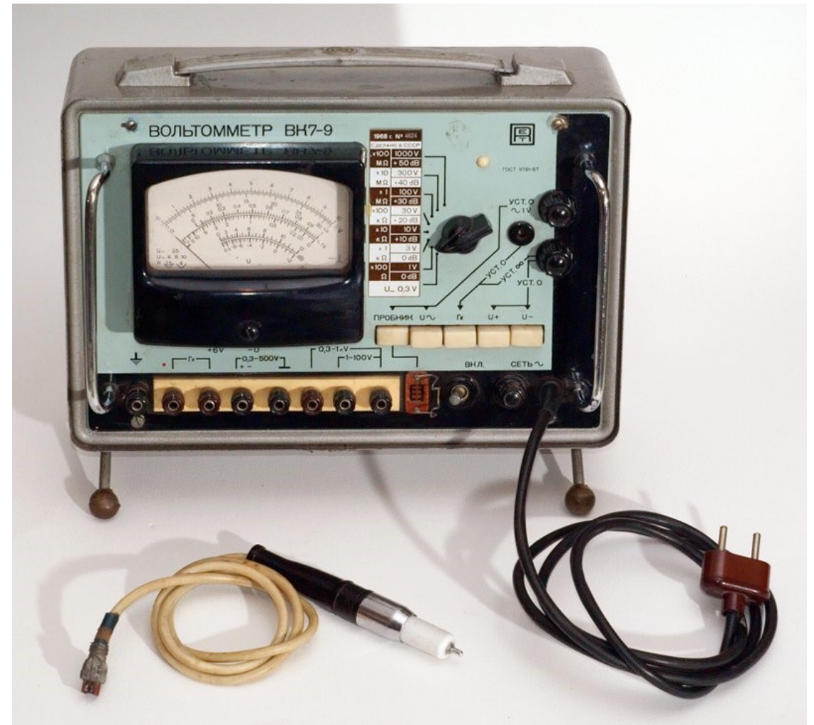
Вольтметр амплитудного значения 0,3 В - 100 В; 20 Гц – 700 МГц
